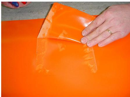
Ob die Schweissnaht in Ordnung ist, erkennt nur der geübte Schweisser von aussen. Absolute Sicherheit gibt nur der Test durch zerstören. Beim Abreissen des Flickens, muss die Schweissung bestehen bleiben, das Obermaterial (PVC) bleibt verschweisst und das Trägermaterial (Polyestergewebe) wird freigelegt.
