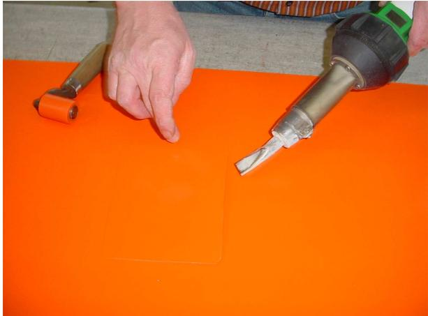
Um ein Loch zu reparieren, wird ein Planenstück auf der entsprechenden Stelle platziert. Zuerst wird ohne Andrückrolle von Hand, der Stoff leicht fixiert. (Geheftet)
