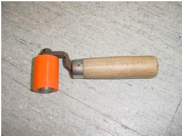
Die Andrückrolle dient dazu um Druck auf die Materialien zu erzeugen, damit das flüssige Planenmaterial optimal verschmelzen kann.
