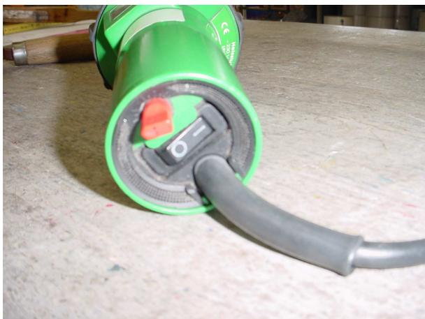
Das Heissluftgebläse wird auf eine Temperatur von ca. 500° C eingestellt. Je nach Präferenz des Schweissers. Grundsätzlich gilt, je heisser die Luft umso schneller muss gearbeitet werden. Die Temperatur ist auf der digitalen Anzeige auf dem Gerät abzulesen. **ACHTUNG:** Nach der Verwendung, muss die Temperatur zurückgestellt werden und das Gerät bei laufendem Gebläse in ca. 10 Minuten abgekühlt werden.
