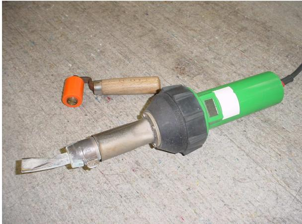
Die Grundausrüstung zum Schweißen von Planenstoffen, besteht aus dem Heissluftgebläse mit einer Breitschlitzdüse und einer Andrückrolle. Die Geräte sind Produkte der Firma Leister.
