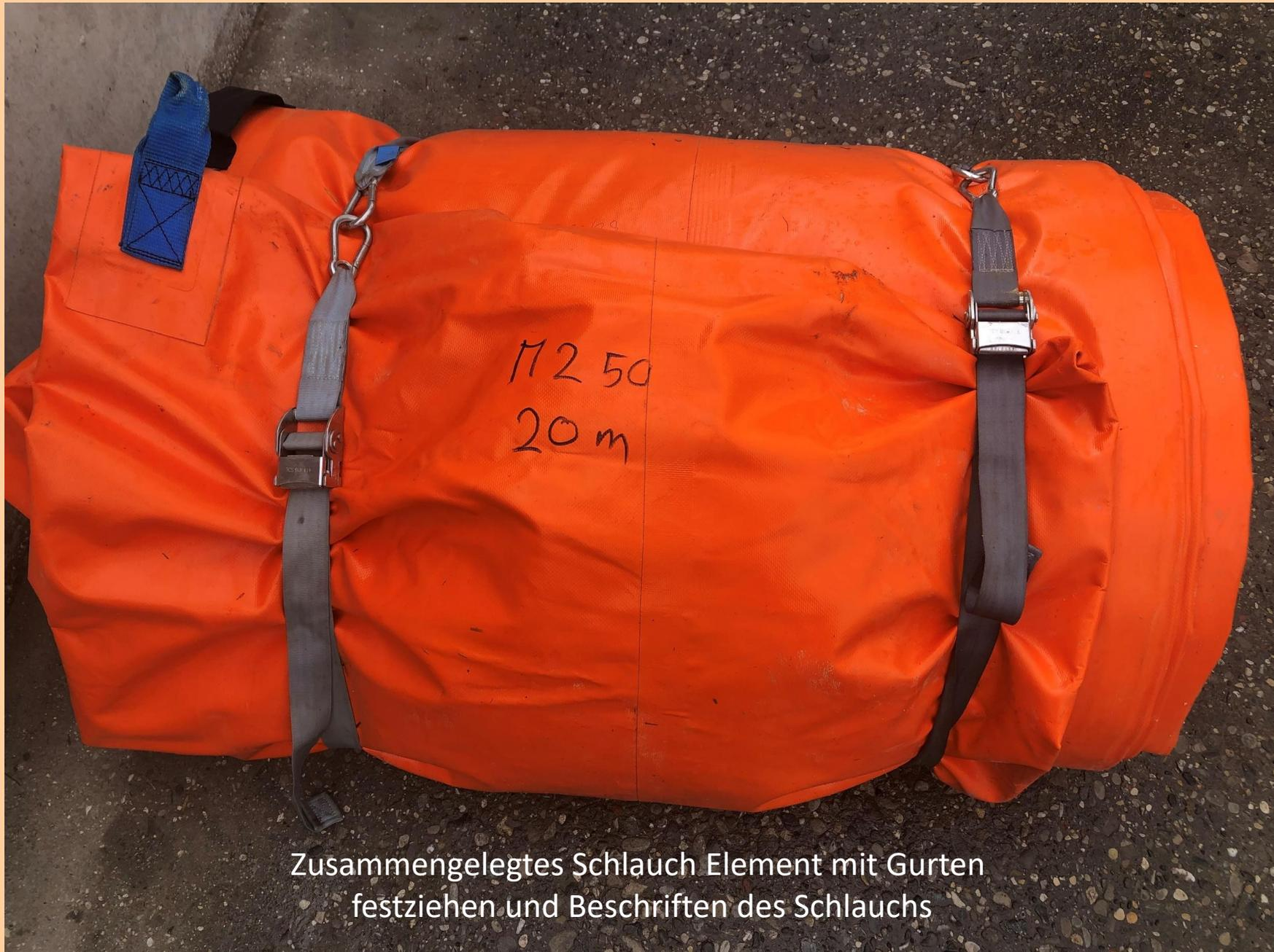
Zusammengelegtes Schlauch Element mit Gurten festziehen und Beschriften des Schlauchs
