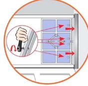
Vertikales Verspreizen (nur nach unten) der Beaver Flood-Gate Türsperre durch Drehen von Stellschrauben mit dem mitgelieferten Ring-Ratschen-Schlüssel
