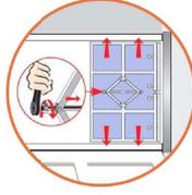
Horizontales Verspreizen der Beaver Flood-Gate Türsperre durch Drehen einer Spindel mit dem mitgelieferten Schraubenschlüssel
